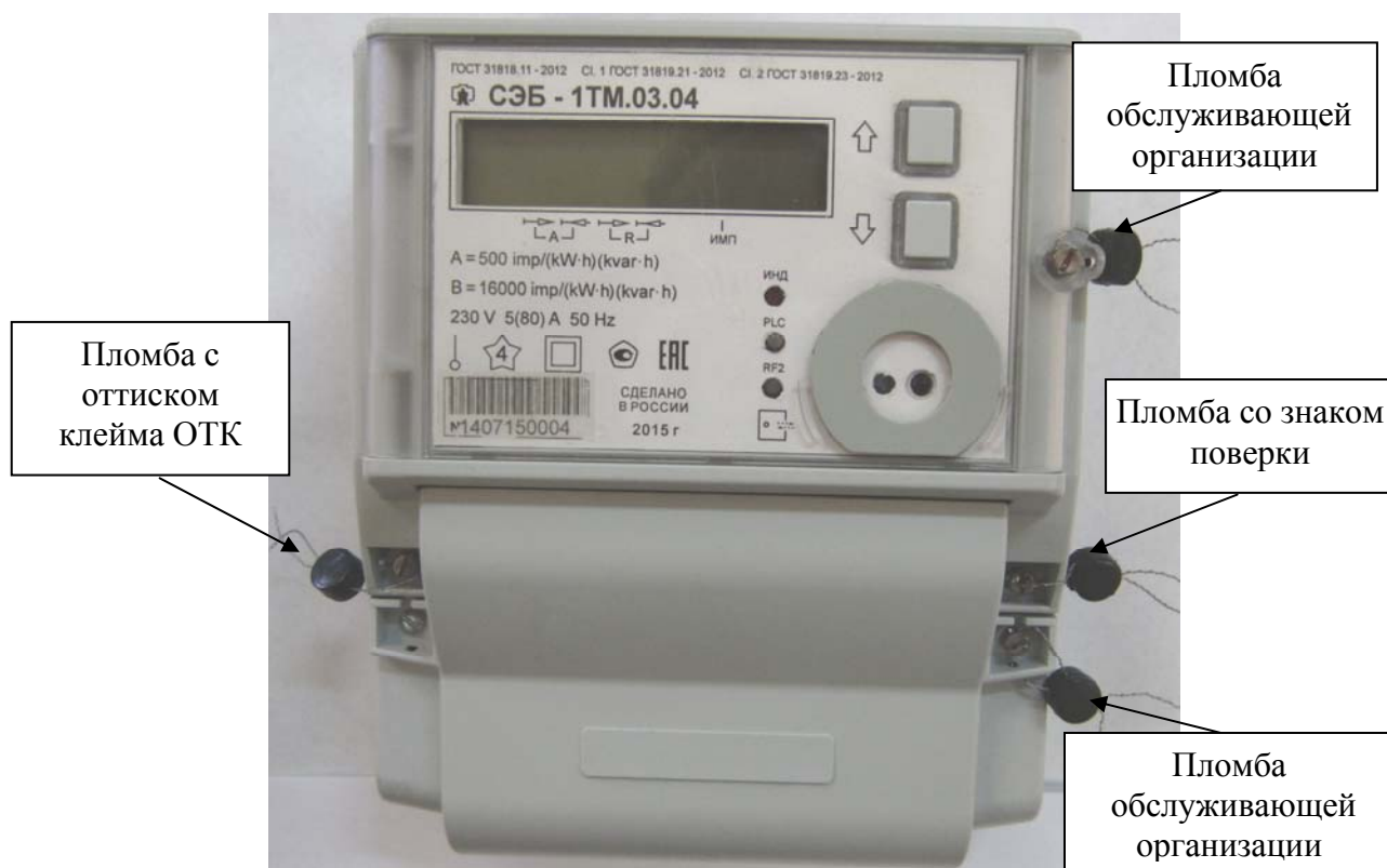
Рисунок 1 – Внешний вид счётчика внутренней установки и схема пломбирования
